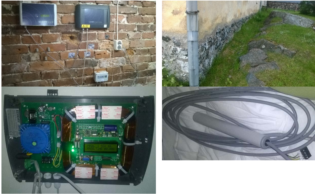
Kuva 5. Seinän kosteudenpoistolaite ja johtokykymittaus seinärakenteeseen asennettulla harja-anturiparilla (vasen yläkuva). Esimerkki kuivatettavasta rakenteesta (oikea yläkuva). Prosessiohjattu kosteudenpoistolaite, master-laite (EcoDry Zeta III) (vasen alakuva). Slave-laite (INPOINT) (oikea alakuva). (Kuvat: Esko Sistonen)
