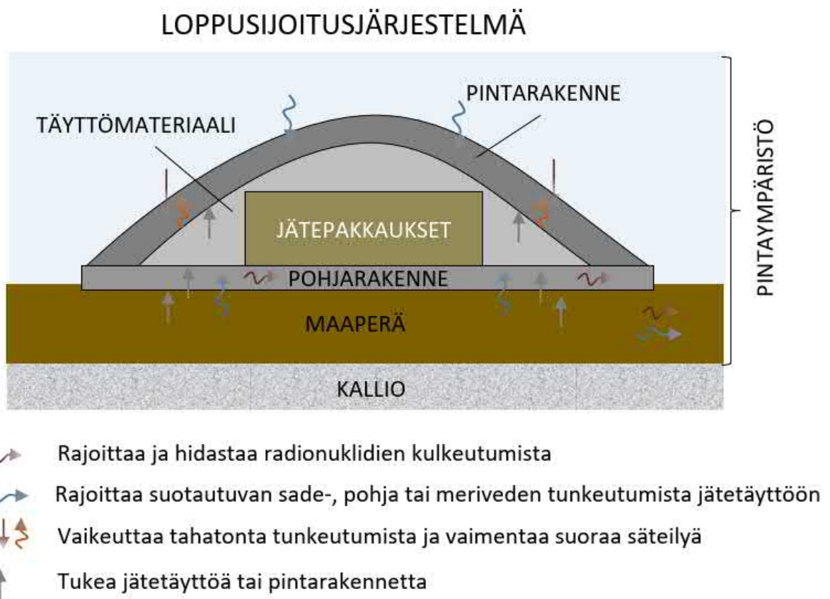
Kuva 3-4. Yksinkertaistettu kuva loppusijoitusjärjestelmän komponenteista sekä eri komponenteille asetetut turvallisuustoiminnot. (Fortum Oyj 2020)
