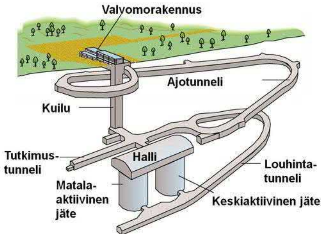
Kuva 3-5. VLJ-luolan toimintaperiaate (havainnekuva).
